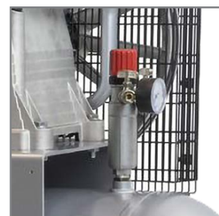
Výstup vzduchu s regulátorem tlaku a 2 rychlospojkami.
