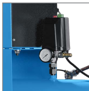
Automatické řízení chodu tlakovým spínačem.
