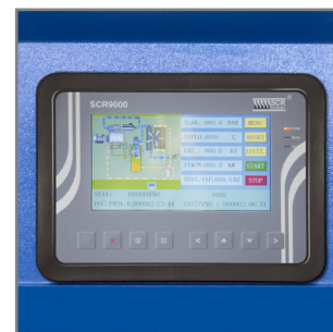
Řídicí jednotka SCR9000 s barevným dotykovým displejem a mnoha funkcemi.
