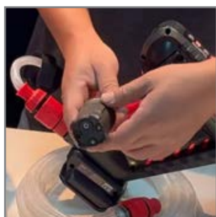
Tryska umožňuje pootáčením změnit tvar a funkci proudění vody.
